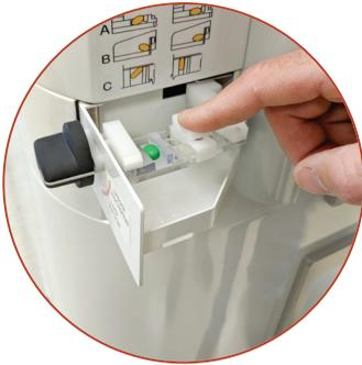
El compartimiento de cámara toma medidas precisas de cada comprimido o cápsula para autocalibrar cada casete, eliminando el error humano.
