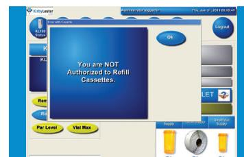
*El sistema de seguridad FillSafe™ evita la dispensación de un casete cuyo relleno no haya sido autorizado previamente por un*
